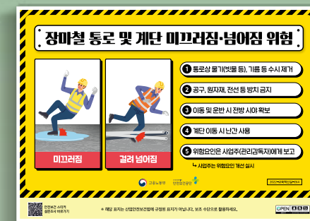
스티커 장마철 통로 및 계단 미끄러짐·넘어짐 위험
