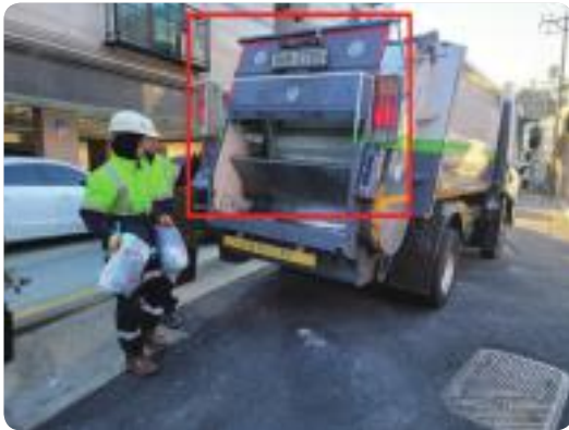
안전 멈춤바, 긴급정지 스위치 및 외부 덮개(파카) 설치
